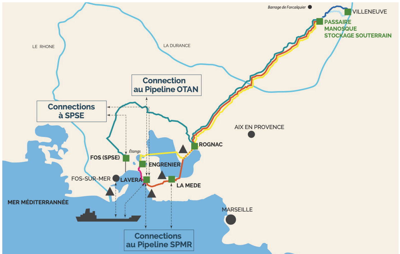
Carte des canalisations de transports d'hydrocarbures et de saumure entre le site de stockage de Manosque, les étangs de Lavalduc et d'Engrenier
